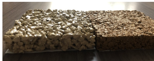
Ces deux enrobés de composition différentes n'auront pas les mêmes propriétés. La plus dense sera plus bruyante par exemple.
