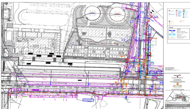
Réseaux divers (eau, électricité, télécom...)
