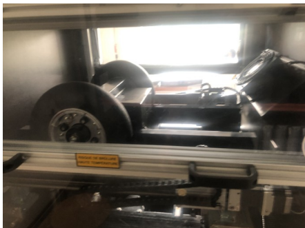
Test d'orniéragé par grand nombre de passages de l'essieu
